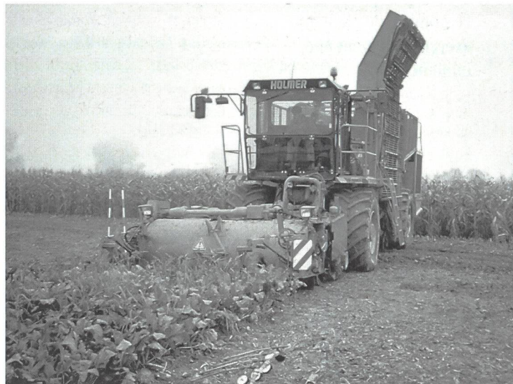
Figure 5: gauche: récolteuse tractée 2 rangs (L1/96), droite: récolteuse automotrice 6 rangs (S1/95). Photos FAT
