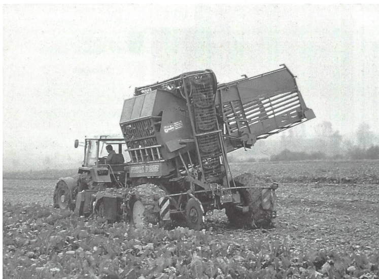
Figure 5: gauche: récolteuse tractée 2 rangs (L1/96), droite: récolteuse automotrice 6 rangs (S1/95). Photos FAT
