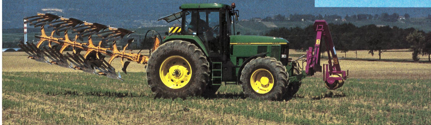
Ill. 4: Devant et derrière, les principaux endroits d'attelage du tracteur.
