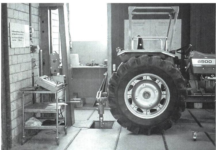
Les outils portés exigent de plus en plus des puissances de relevage hydraulique en constante augmentation. Le rapport FAT indique la puissance de levage sur toute la course de levage. Des vérins additionnels peuvent augmenter la puissance de levage jusqu'à 50%.
