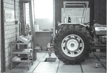
Les outils portés exigent de plus en plus des puissances de relevage hydraulique en constante augmentation. Le rapport FAT indique la puissance de levage sur toute la course de levage. Des vérins additionnels peuvent augmenter la puissance de levage jusqu'à 50%.
