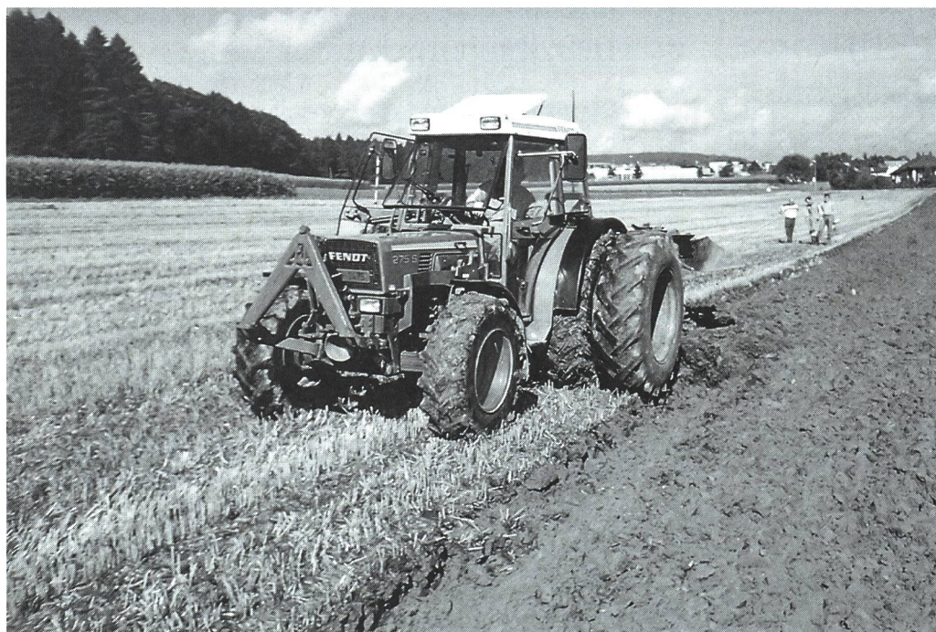
Charrues «onland»: Les roues ne tassent et ne lissent plus le fond du sillon.
