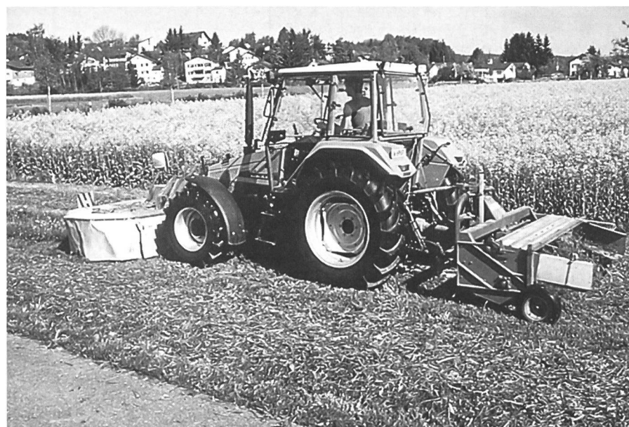
Fig. 6. Le capot incliné vers l'avant améliore considérablement la vue sur l'outil frontal, ce qui est appréciable pour l'accouplement comme pour l'utilisation du tracteur dans les champs.
