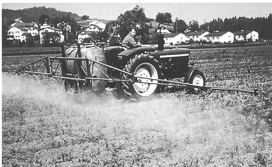
Fig. 4. Le tracteur polyvalent des années 70 possédait un moteur de 45 à 55 CV, était équipé d'une propulsion arrière, d'une prise de force normalisée et d'un système hydraulique aux trois points. Son poids était inférieur à 2500 kg.
