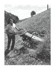
216. L'enclenchement en marche arrière à partir de n'importe quelle vitesse est particulièrement appréciable. A cet effet, la poignée, à droite sur le mancheron, est actionnée sans lâcher les guidon.
