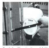
fig. 4. La détermination préalable de l'angle de service et la position horizontale de l'appareil permettent de régler précisément la position des tôles de guidage et des buses.
