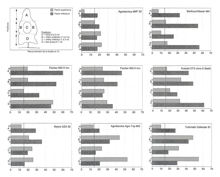
fig. 6. Degré de recouvrement sur les feuilles dans les 4 positions en % (valeur médiane) (chiffres de gauche: Exemple Fischer 800, A 38 = 38% des feuilles examinées ont un degré de recouvrement inférieur à la limite de 15%).
