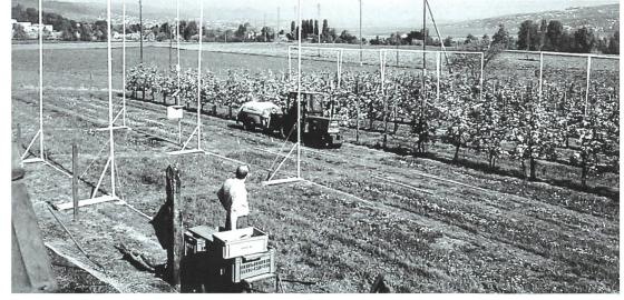
fig. 9. Les pertes par dérive ont été déterminées au moyen de bandes de papier filtre placées sur des lattes borizontales et verticales et feuillage complètement développé (ill.: mesure lors de la floraison).
