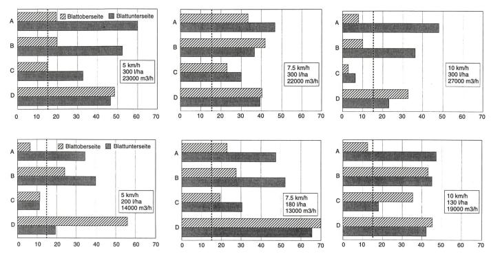
fig. 8. Recouvrement des feuilles en % selon la vitesse de déplacement de 2 pulvérisateurs: ci-dessus: Fischer 800; ci-dessous: Krobath avec électrostatique (A jusqu'à D = comme fig. 6).
