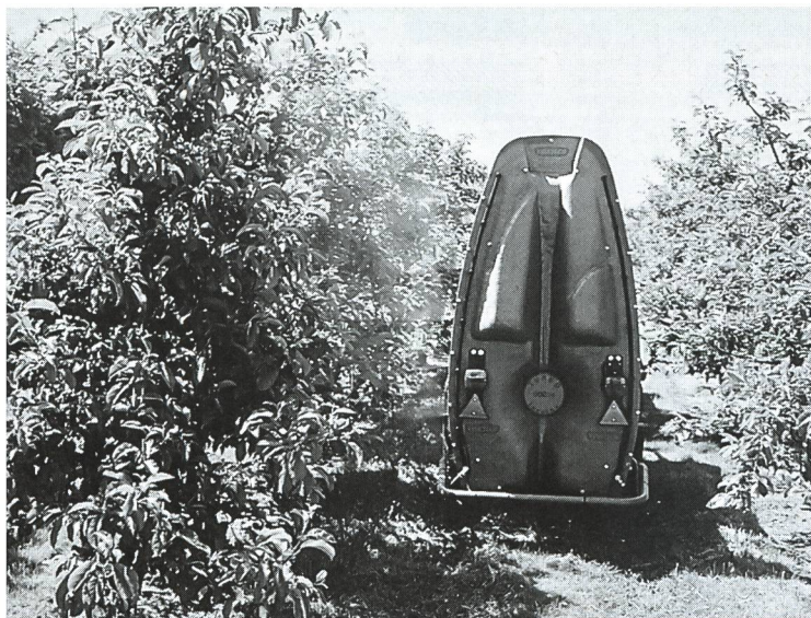
fig. 5. Avec le souffleur axial inversé, les gouttelettes sont portées par le flux d'air sur une distance relativement courte jusqu'à la surface à traiter (Fischer 800, mesure du recouvrement des feuilles).
