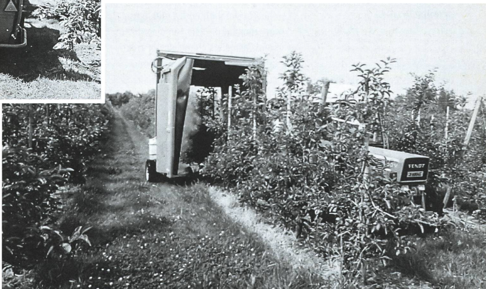
fig. 5. Avec le souffleur axial inversé, les gouttelettes sont portées par le flux d'air sur une distance relativement courte jusqu'à la surface à traiter (Fischer 800, mesure du recouvrement des feuilles).
