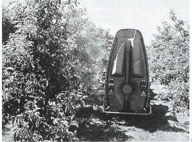
fig. 5. Avec le souffleur axial inversé, les gouttelettes sont portées par le flux d'air sur une distance relativement courte jusqu'à la surface à traiter (Fischer 800, mesure du recouvrement des feuilles).
