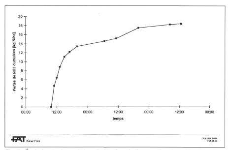
Fig. 3. Évolution typique de la volatilisation de l'ammoniac durant les deux premiers jours qui suivent l'épandage du lisier. Essai en plein champ avec du lisier de bovins complet dilué à 1:1, 34 m³ par ha, épandage à 10 heures, température de 18,1 °C au moment de l'épandage.
