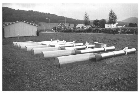
Fig. 2. Tunnels aérodynamiques pour mesurer les pertes d'ammoniac: faire varier progressivement un paramètre préalablement défini (p. ex. le degré de dilution), permet d'étudier de manière ciblée son influence sur les pertes.
