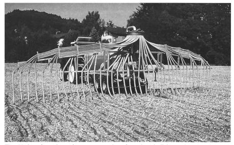
Fig. 11. Les épandeurs à tuyaux souples répandent le lisier en bandes, à proximité immédiate du sol. La surface de contact du lisier réduite induit des pertes d'ammoniac nettement plus faibles.
