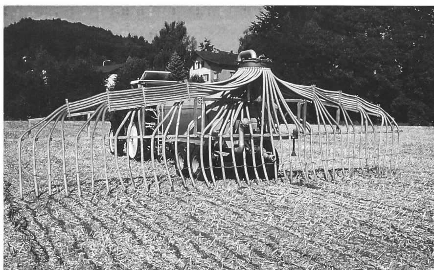
Fig. 11. Les épandeurs à tuyaux souples répandent le lisier en bandes, à proximité immédiate du sol. La surface de contact du lisier réduite induit des pertes d'ammoniac nettement plus faibles.
