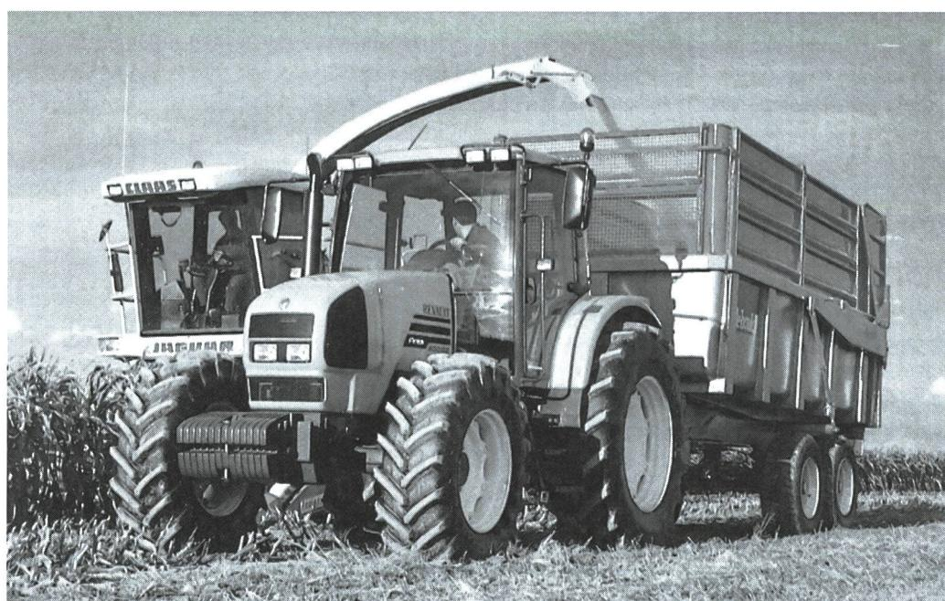
sous les roues. Une fois encore c'est la simplicité d'utilisation qui a été au centre de la démarche de Renault-Agriculture dans le concept TCE 20. En effet, une simple pression sur le bouton d'activation de la gestion active de patinage déclenche automatiquement le calcul du patinage, le positionnement de la butée maxi admissible et l'activation du système sur l'outil.
