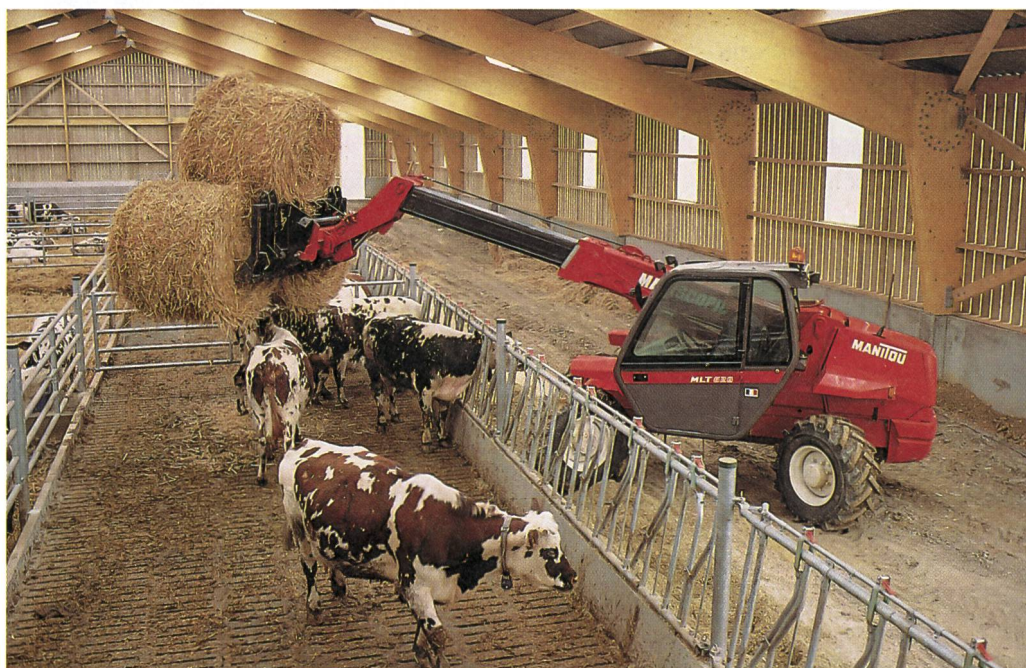
Exploitation d'engraissement française: Le chargeur télescopique permet de faire simplement la liaison entre les éléments abritant le bétail et devient ainsi un véhicule central pour la mécanisation intérieure de la ferme.
