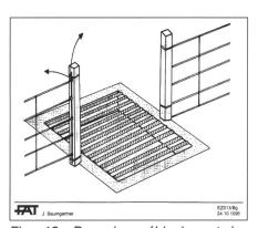
Fig. 13. Pour les véhicules et les piétons, on utilise aussi des grilles. Dans ce cas, il ne faut pas oublier le raccord électrique entre les deux extrémités de la clôture.
