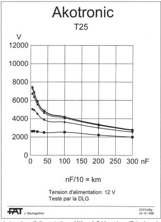
Fig. 7. Si la source de courant est constituée d'une pile sèche, la tension d'alimentation s'élève à 9 V environ (7c), dans le cas d'une batterie automobile, à 12 V (7d).
