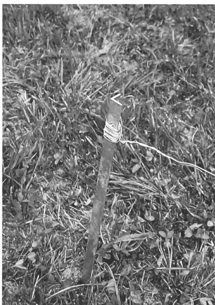
Fig. 8. La mise à la terre est bonne lorsque le contact électrique entre la sonde et l'appareil se fait sans grande résistance (rouille, fil de fer détaché ou trop fin).
