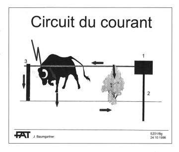
Les herbes ou les buissons qui touchent le conducteur, et les mauvais isolateurs dévient une partie de l'impulsion, en réduisant ainsi l'effet sur l'animal, ce qui porte préjudice à l'efficacité du système.
