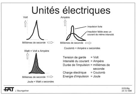
Fig. 4. Toutes les 1 à 1,5 secondes, l'électrificateur délivre une impulsion dans la clôture. Celle-ci est constituée de courant et de tension et ne dure que quelques millièmes de secondes. Ces données permettent de calculer les autres valeurs d'évaluation.
