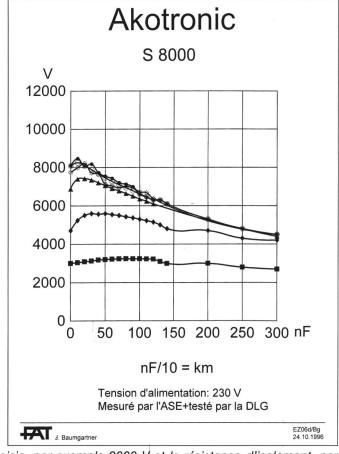
Fig. 6. L'intersection entre la tension de garde minimum choisie, par exemple 2000 V et la résistance d'isolement, par exemple 0,5 kOhm (contact corporel), indique la longueur possible de la clôture en km (km = nF/10), sachant que la clôture n'a qu'un fil (par exemple, sur la figure 6b,18 km).
