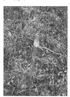
Fig. 8. La mise à la terre est bonne lorsque le contact électrique entre la sonde et l'appareil se fait sans grande résistance (rouille, fil de fer détaché ou trop fin).
