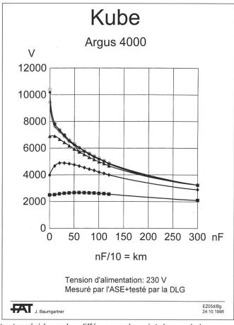
Fig. 5. Trois appareils reliés au réseau et un appareil à piles mettent en évidence les différences du point de vue de la source de courant. Lorsque les tensions d'alimentation sont comprises entre 220 et 230 V, il s'agit toujours d'appareils reliés au réseau.
