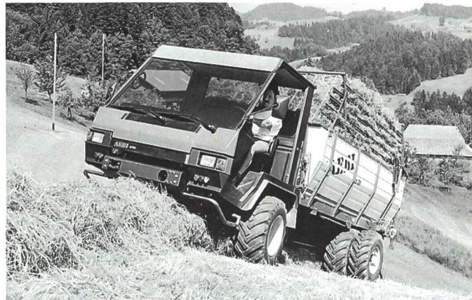
*Le Transporteur Aebi TP98 redéveloppé permet à l'usager d'éviter d'inutiles efforts, grâce à la nouvelle suspension pneumatique et autres éléments de confort exemplaires. Il offre une plus grande charge utile, un nouveau moteur Diesel VM performant et de bonne reprise, une nouvelle boîte à vitesses et un rayon de braquage de 52°.*
