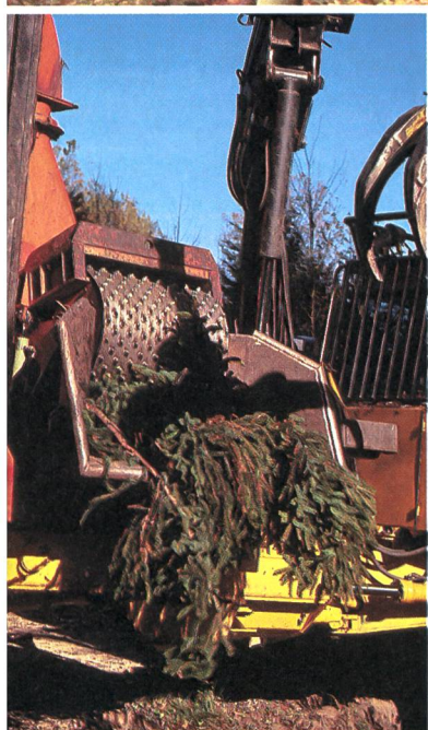
La déchiqueteuse mobile possède la faculté d'engloutir en quelques secondes les branches et les couronnes de sapins, hêtres ou charmes.
