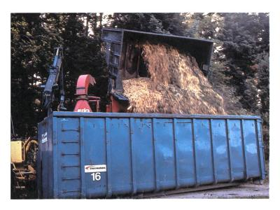
Une fois sa benne de  $15 \text{ m}^3$  remplie, la déchiqueteuse déverse les copeaux dans une benne plus grande de  $50 \text{ m}^3$ .
