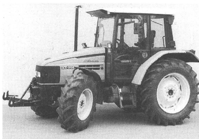
Fig. 5. Tracteur HÜRLIMANN XT 908 Turbo, avec transmission à passage sous charge (3 étages par vitesse), système hydraulique frontal et prise de force frontale.
