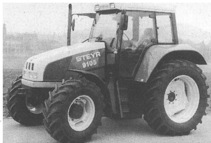
Fig. 3. Tracteur STEYR 9105 Turbo, avec transmission à passage sous charge (4 étages par vitesse) (Steyr-Power).
