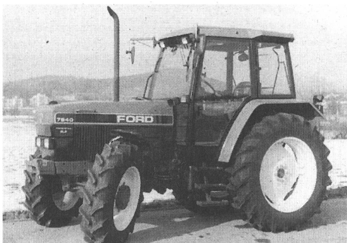
Fig.4. Tracteur FORD 7840, avec transmission à passage sous charge (4 étages par vitesse) (Electro Shift).
