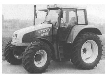
Fig. 3. Tracteur STEYR 9105 Turbo, avec transmission à passage sous charge (4 étages par vitesse) (Steyr-Power).
