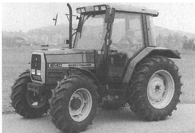
Fig. 2. Tracteur MASSEY FERGUSON 6140 Turbo, avec transmission à passage sous charge (4 étages par vitesse) (Dynashift).
