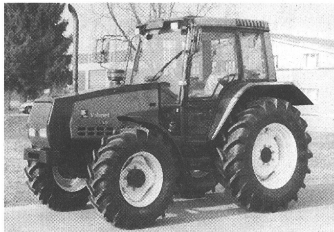
Fig. 1. Tracteur VALMET 6400 Turbo, avec embrayage hydraulique et transmission à passage sous charge (3 étages par vitesse) (Powershift).
