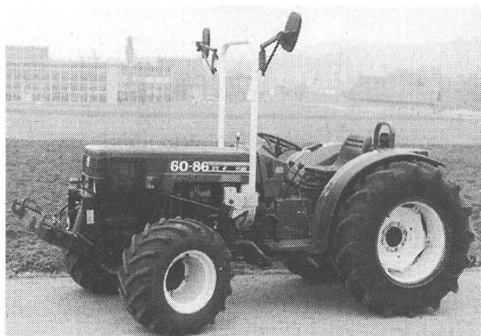
Fig. 7. Tracteur FIAT 60 – 86 F, conçu pour la culture fourragère, avec système hydraulique frontal et prise de force frontale.
