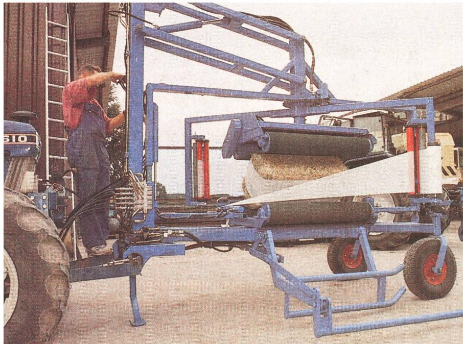
Pour les entrepreneurs agricoles c'est une machine performante qui peut se placer indifféremment à l'avant ou à l'arrière. Deux rouleaux accélèrent le processus d'enrubannage. Grâce à une pression élevée de chaque côté, les balles sont très compactes.
