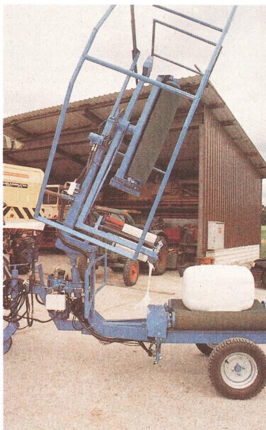
Equipement minimum, sans récupération des balles et procédé d'enrubannage manuel ou automatique (coût: Fr. 16 000.-). Le cadre de sécurité est repliable pour les trajets sur route.
