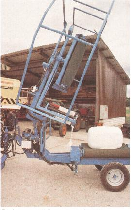
Equipement minimum, sans récupération des balles et procédé d'enrubannage manuel ou automatique (coût: Fr. 16 000.-). Le cadre de sécurité est repliable pour les trajets sur route.
