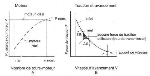
fig. 2: A: Courbes de puissance idéale et réelle (pratique) d'un moteur et B: Leur effet sur la force de traction et la vitesse d'avancement. (Les fig.2, 3 et 4 proviennent de l'auteur)
