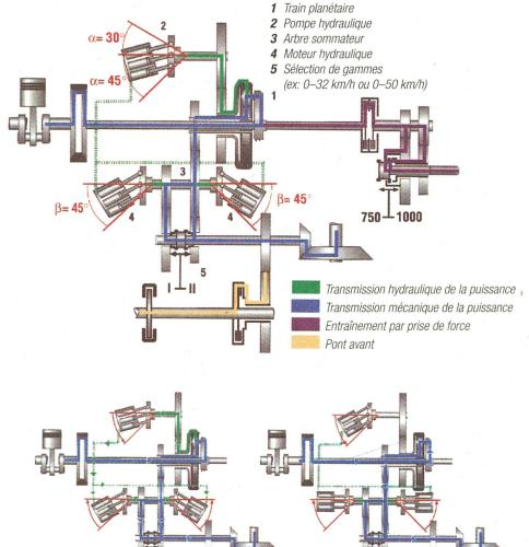
fig. 1: Schéma de la transmission de tracteur mécanique-hydrostatique de Fendt.
