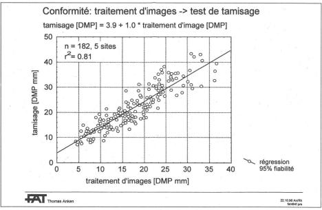
Fig. 11. La droite de régression entre le test de tamisage (DMP) et le traitement d'images (DMP) explique 81% des fluctuations des valeurs relevées.
