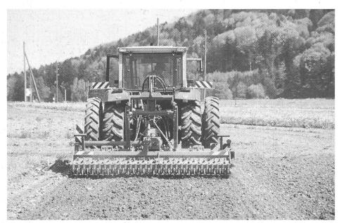
Fig. 2. La herse rotative à axe horizontal est efficace et requiert peu de force de traction.
