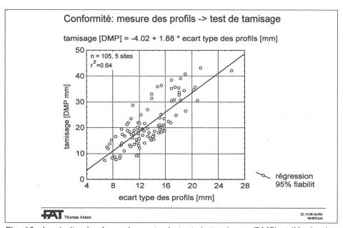
Fig. 12. La droite de régression entre le test de tamisage (DMP) et l'évaluation de la rugosité (écart type des profils en mm) explique 64% des fluctuations des valeurs relevées.
