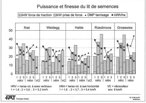
Fig. 5. Force de traction (kW), puissance à la prise de force (kW), énergie nécessaire, par hectare (kW/ha) et diamètre moyen pondéré des mottes avec le test de tamisage (DMP), relevés sur cinq sites différents.
