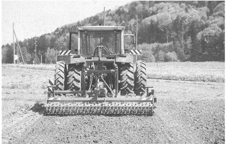
Fig. 2. La herse rotative à axe horizontal est efficace et requiert peu de force de traction.
