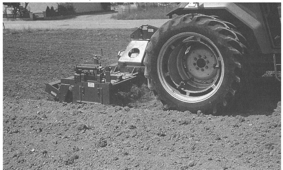
Fig. 3. La herse rotative à axes verticaux nivelle bien les parcelles. C'est l'outil avec lequel on obtient le sol le plus fin, mais c'est aussi un outil qui demande une importante force de traction lorsque la vitesse d'avancement est élevée.
