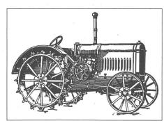
Tracteur IHC 10-20, année de construction 1926, avec disque à courroie et prise de force à l'arrière.
