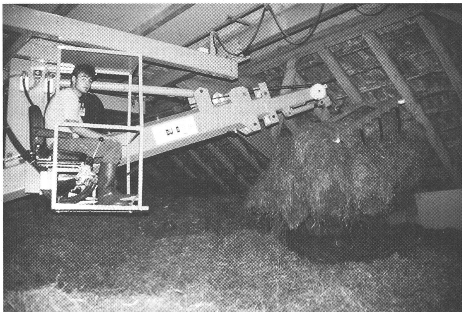
Fig. 7. Les grues à griffe servent à l'engrangement et à la reprise du fourrage. En cas d'utilisation d'huile hydraulique minérale, les pertes d'huile, provoquées par des fuites, peuvent porter atteinte à la santé des animaux.
