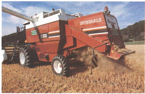
La hacheuse à paille est devenue un équipement standard des moissonneusesbatteuses. La précision d'épandage de la paille n'est pas assurée sans autre. Il faut également garantir sa régularité même lorsque le vent souffle.
