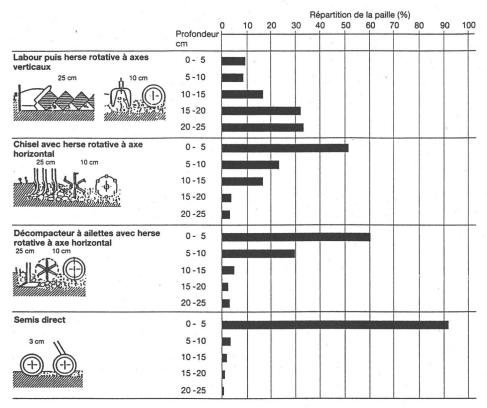
Fig. Répartition de la paille en pour-cent dans le sol en fonction du procédé de travail. (Source: Grandes cultures, 1<sup>er</sup> partie: Travail du sol; avec l'aimable accord de la Centrale des moyens d'enseignement de Zollikofen)
