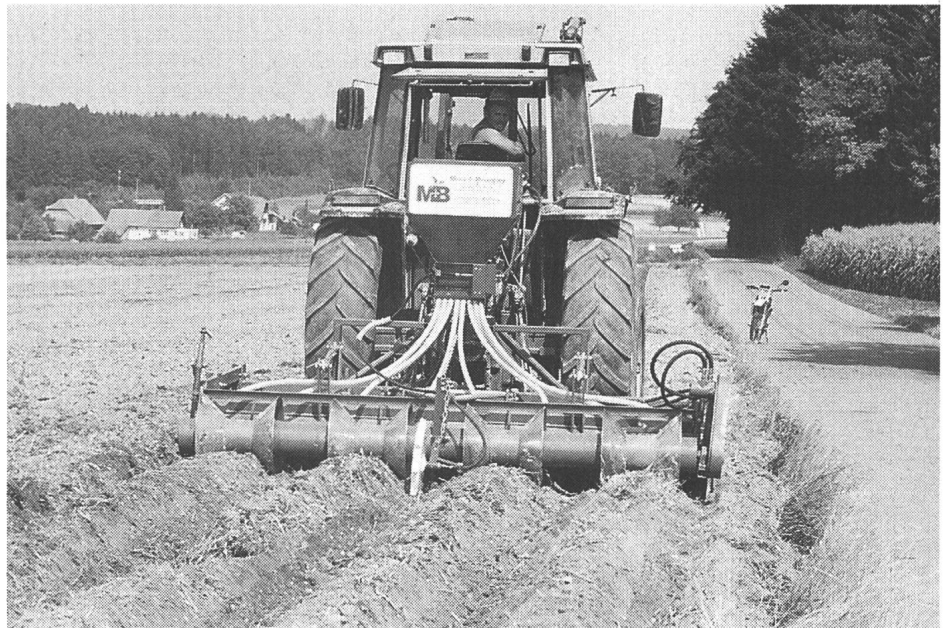
Confection des buttes avec semis simultané d'un engrais vert. Les rouleaux pressent la semence dans la terre.
