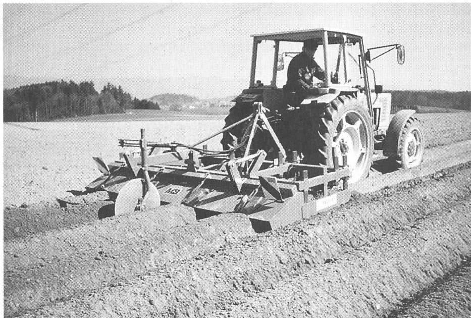
Butteuse polyvalente (sans rouleaux et sans semoir), préparation des buttes. Lutttes contre les adventices jusqu' à une hauteur de 35 cm des fanes qui passent par des ouvertures réglables.
