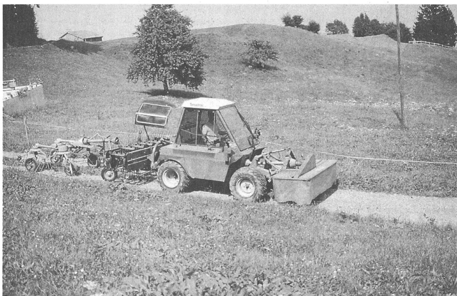
Fig. 1. Il est intéressant d'avoir deux points d'attelage (dispositif de levage frontal et arrière) surtout lorsque les parcelles sont éloignées. Cela permet en effet de transporter simultanément deux, ou même trois outils jusqu'au champ.
