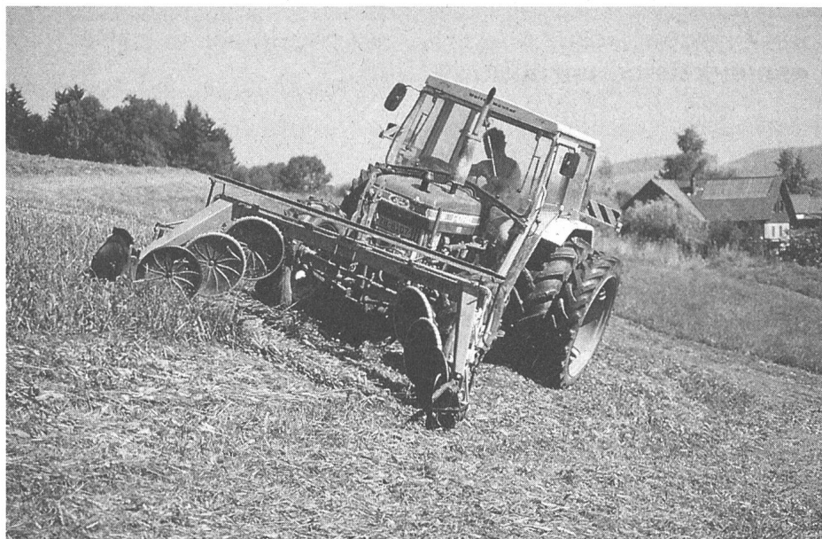
Fig. 2. Le tracteur équipé de roues jumelées est très stable dans les terrains en pente. La limite de son utilisation se situe dans les terrains dont le pente avoisine 35%, car à partir de là, il ne permet plus de travailler en ménageant le sol.
