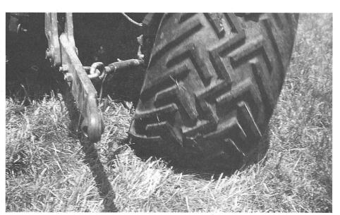
Fig. 4. Le pneu Terra, souple, supporte des valeurs de dérive et de patinage relativement élevées, avant de causer des dommages au sol.
