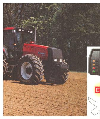
Valmet 8750: un module de commande  $\Sigma$ -power augmente la puissance du 6 cylindre lorsque la prise de force nécessite un couple élevé.
