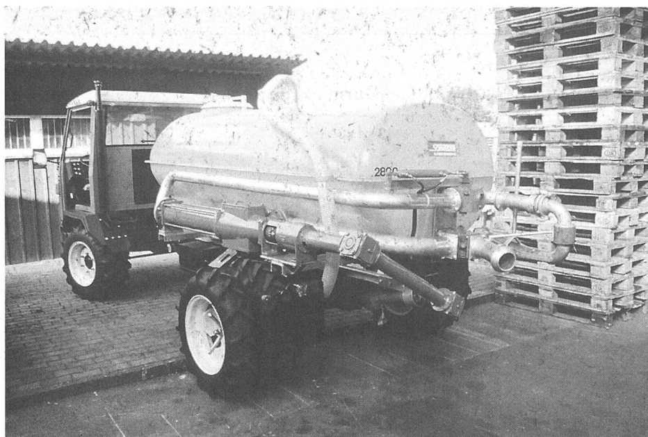
Utilisation polyvalente de la citerne à pression ou à pompe (photo: Zw.).
