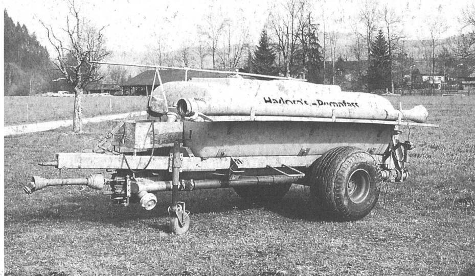
Citerne à pompe équipée d'une pompe à piston tournant (photo: A. Moser).
