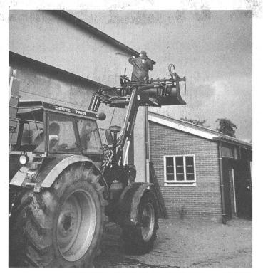
Le chargeur frontal permet de réaliser une multitude de travaux qui vont de la plate-forme de travail au chargement de betteraves sucrières.
