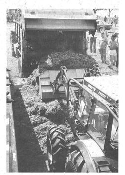
La répartition de l'ensilage dans un silo-tranchée, comme les travaux de terrassement, implique un cylindre hydraulique à double action.
