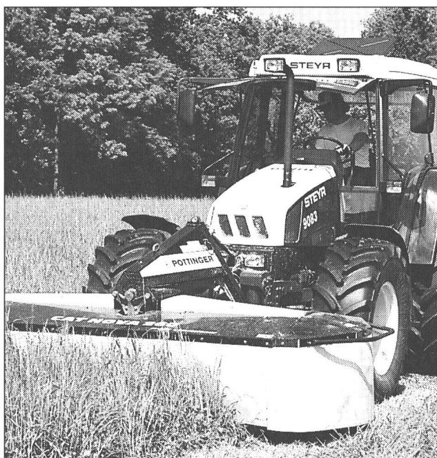
Faucheuse rotative frontale Cat Nova CR 2 modèles, largeur de travail de 2,58 ou 3 m
