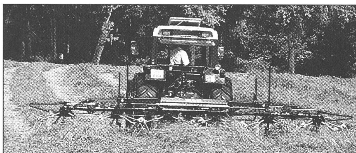
Faneuse rotative HIT: large au travail, étroite au transport
