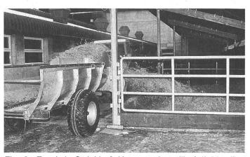
Fig. 6. Essai de Strickhof. L'apport de paille à l'aide d'un distributeur latéral simplifie considérablement le travail. C'est aussi la solution la plus rentable. Il faut cependant que l'aire d'exercice ait été nettoyée au préalable.
