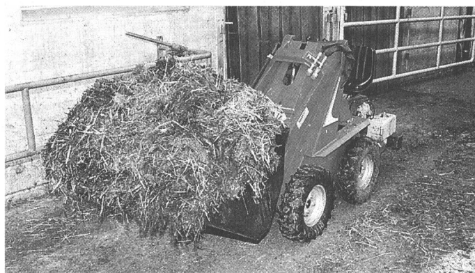
Fig. 8. Essai de Strickhof. Dans l'aire d'exercice, le fumier est évacué à l'aide d'un petit chargeur. L'emploi d'un racleur et l'aménagement d'une fumière à proximité de l'étable seraient plus avantageux du point de vue de l'organisation du travail.
