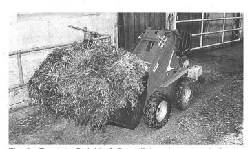
Fig. 8. Essai de Strickhof. Dans l'aire d'exercice, le fumier est évacué à l'aide d'un petit chargeur. L'emploi d'un racleur et l'aménagement d'une fumière à proximité de l'étable seraient plus avantageux du point de vue de l'organisation du travail.
