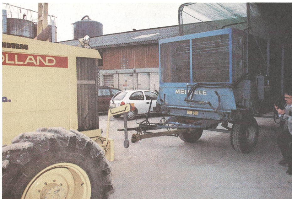
Couplage automatique de la remorque pour l'ensilage sûr et rationnel du maïs.
