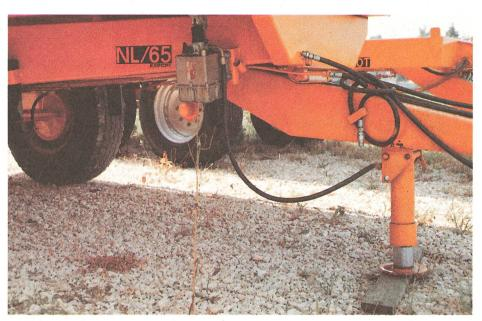
Appui d'une remorque basculante actionné par un système hydraulique.
