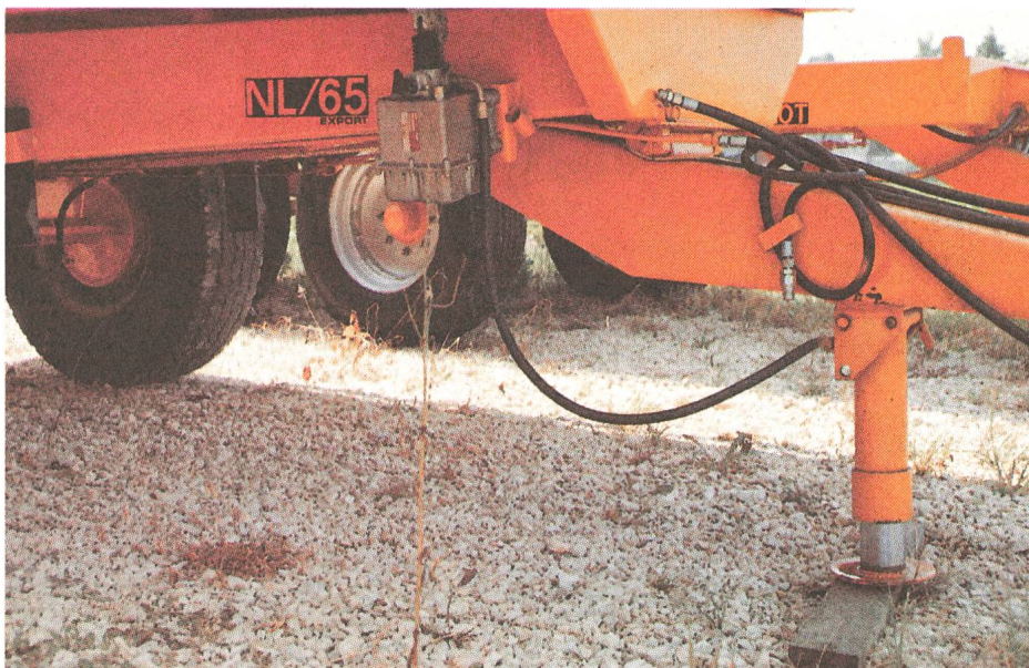
Appui d'une remorque basculante actionné par un système hydraulique.
