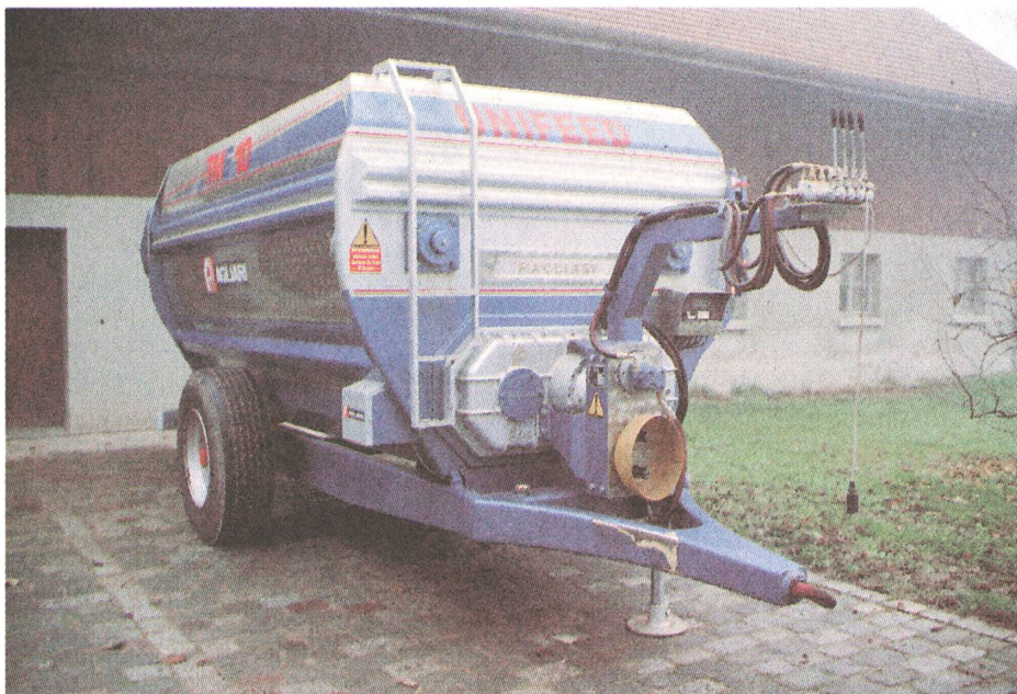
Charge du timon élevée: les remorques mélangeuses sont adaptées pour un système d'attelage bas.
