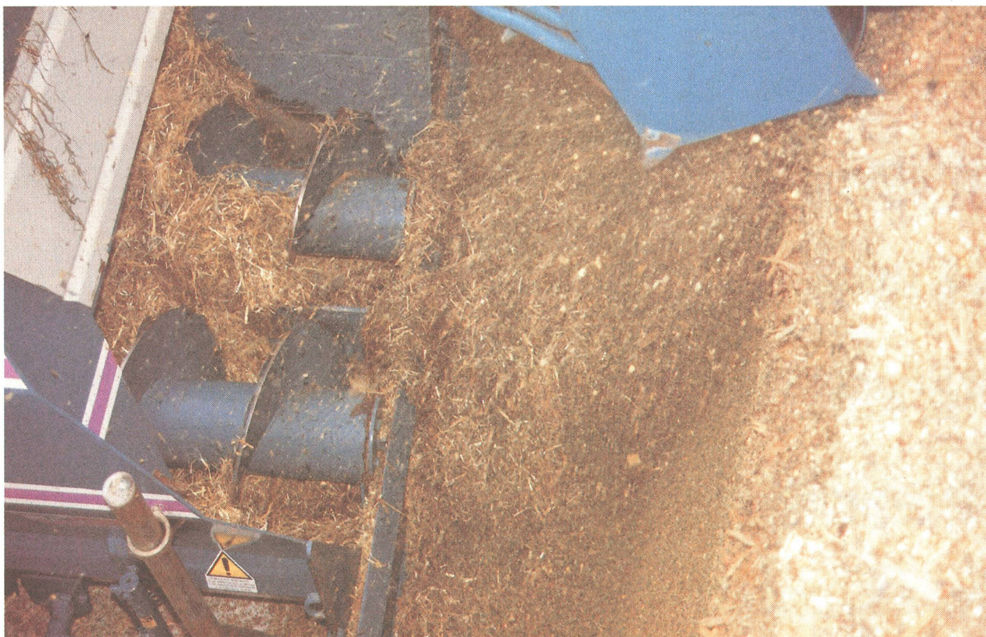
Les différentes fonctions: remplissage, pesage, mélange, transport et distribution expliquent le coût élevé des remorques mélangeuses.
