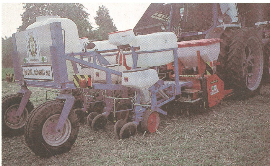
Appareil de la dernière génération (par W. Witzig) avec roues d'appui visant à soulager l'axe du tracteur. Réservoir pour l'azote, le granulé et pour la régulation séparée des mauvaises herbes dans et entre les bandes.
