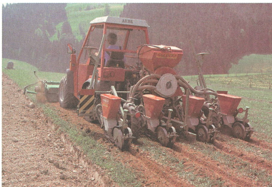
Appareil de la dernière génération (par W. Witzig) avec roues d'appui visant à soulager l'axe du tracteur. Réservoir pour l'azote, le granulé et pour la régulation séparée des mauvaises herbes dans et entre les bandes.
