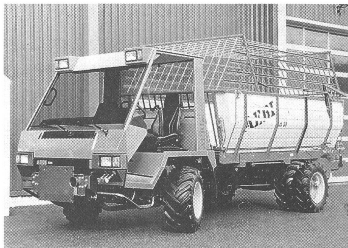
Grâce à la nouvelle suspension pneumatique et autres éléments de confort, le Transporter Aebi remanié épargne à l'utilisateur d'inutiles fatigues. Il offre une charge utile plus élevée, une nouvelle boîte de vitesses et un rayon de braquage de 52°.
