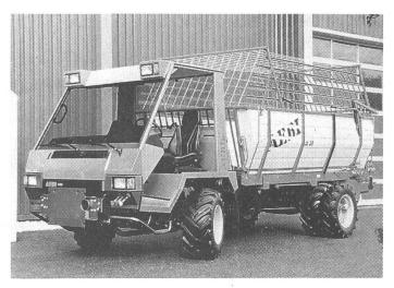
Grâce à la nouvelle suspension pneumatique et autres éléments de confort, le Transporter Aebi remanié épargne à l'usager d'inutiles fatigues. Il offre une charge utile plus élevée, une nouvelle boîte de vitesses et un rayon de braquage de 52°.
