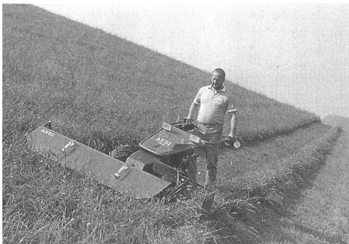
La nouvelle faucheuse pour herber Aebi AM42 avec direction active, transmission hydrostatique et répartition variable du poids. Disponible également avec le forme-andain à fourche robuste et d'un prix avantageux.
