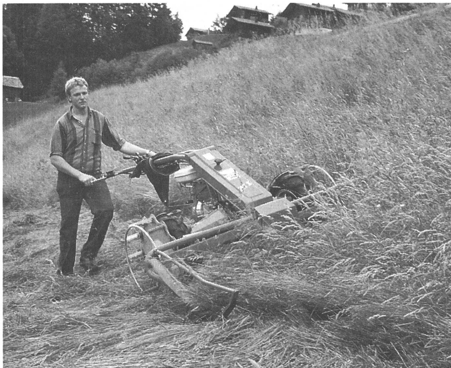
La voie large et le dispositif de guidage au frein facilitent l'utilisation de la motofaucheuse.
