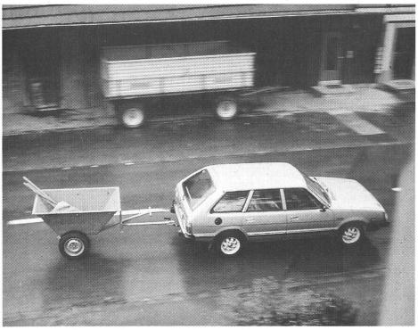
Chariot d'ensilage, tonneaux abreuvoirs, tanks à lait et petites remorques de transport peuvent être attelées aux  $4 \times 4$  en roulant à 30 km/h seulement.
