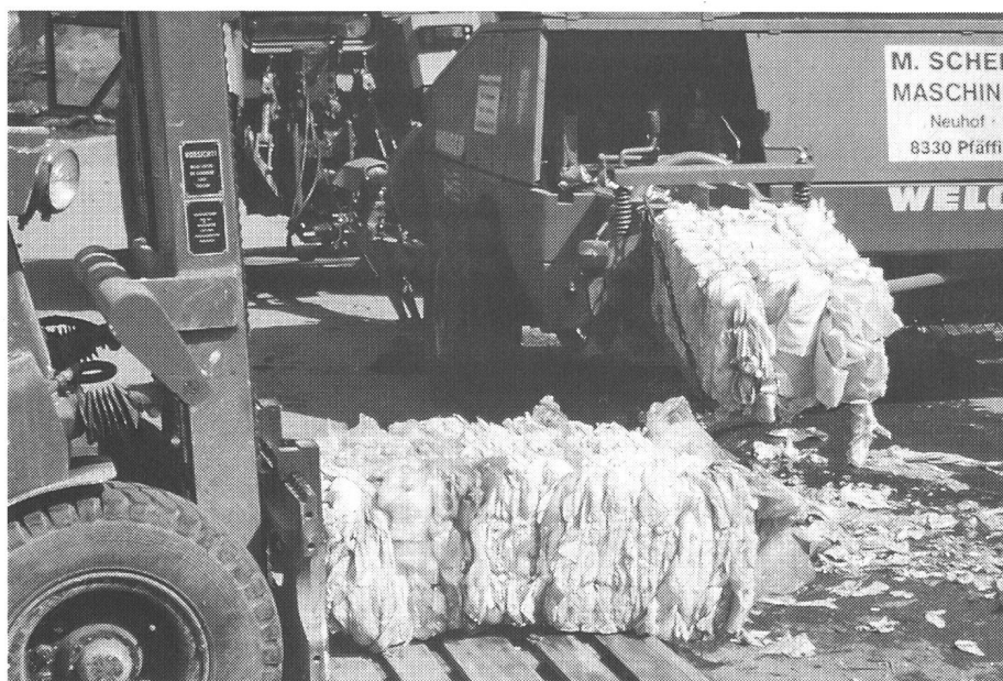
Important: des balles pressées avec soin; dans ce cas: 0,95×0,48×0,37 m. Poids: 60 kg. Des balles carrées plus lourdes sont acceptées, mais il faut penser à la manutention.
