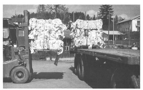
Liées sur une palette, six balles de 60 kg. Cette forme de balle permet de maintenir les frais de transport dans des limites supportables.
