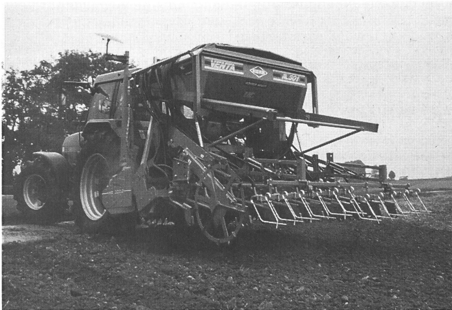
Le semoir VENTA se caractérise par une trémie indépendante du châssis.
