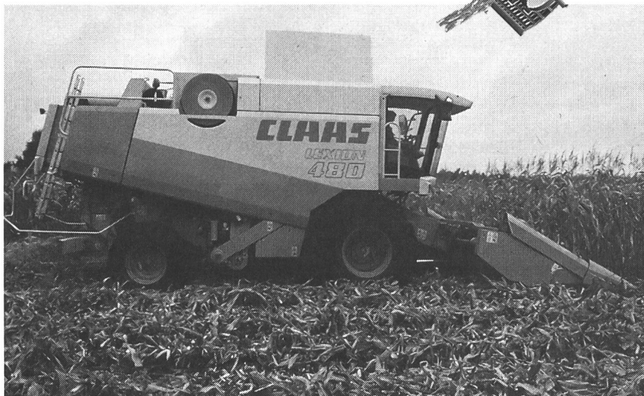
LEXION 480, cueilleur à 8 rangs en action. On distingue nettement la trémie à parois rabattables et le moteur, placé derrière. (Photo: Zw.)
