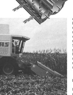
LEXION 480, cueilleur à 8 rangs en action. On distingue nettement la trémie à parois rabattables et le moteur, placé derrière. (Photo: Zw.)
