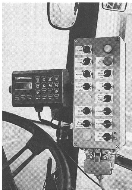
*Console pour le réglage et le dosage électro-hydraulique.*
