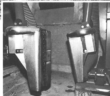
Effeuilleuse munie d'un guidage au sonar.
