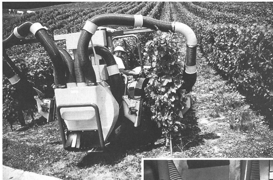
Effeuilleuse munie d'un guidage au sonar.
