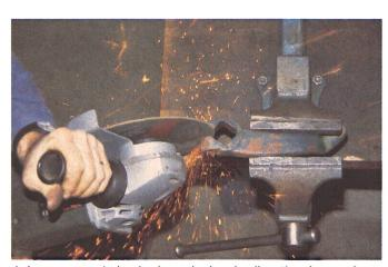
4. Le serrage de la vis de ce levier de direction à «carré» ne permet plus une attache maximale. Un meulage de l'ouverture du carré permet d'y remédier. La vis de serrage sera toutefois changée.
