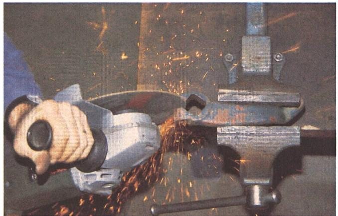
4. Le serrage de la vis de ce levier de direction à «carré» ne permet plus une attache maximale. Un meulage de l'ouverture du carré permet d'y remédier. La vis de serrage sera toutefois changée.
