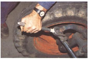
3. Pour le démontage de la rotule, on enlèvera d'abord la clavette de sécurité, puis on dévissera l'écrou de quelques tours. Débloquez la rotule en tapant de manière déterminée sur le côté du siège de la rotule. (Répondre de l'autre côté avec un gros marteau.)
