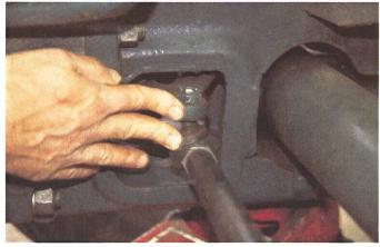
1. Pour commencer, contrôler minutieusement toute la «tringlerie» de direction en allant du volant jusqu'aux roues. En appuyant légèrement deux doigts entre une barre de direction et sa rotule et en bougeant le volant dans un sens dans l'autre, on remarquera le jeu de la rotule.
