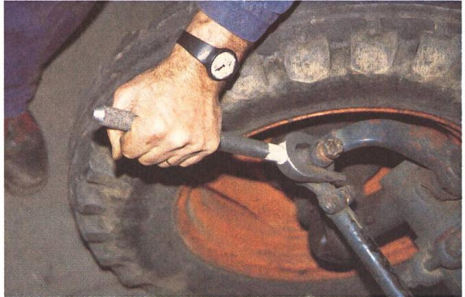
3. Pour le démontage de la rotule, on enlèvera d'abord la clavette de sécurité, puis on dévissera l'écrou de quelques tours. Débloquez la rotule en tapant de manière déterminée sur le côté du siège de la rotule. (Répondre de l'autre côté avec un gros marteau.) Si, par manque de place, il n'est pas possible de procéder de cette manière, on utilisera un extracteur (photo).
