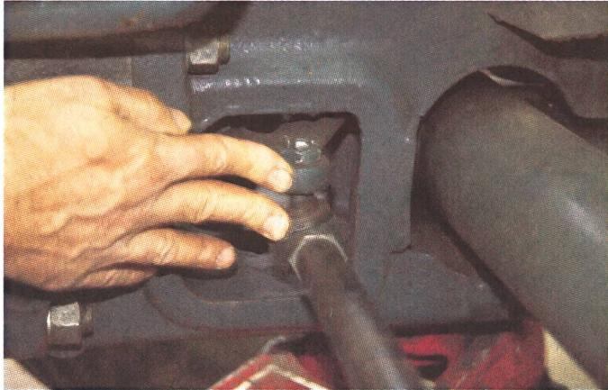
1. Pour commencer, contrôler minutieusement toute la «stringerie» de direction en allant du volant jusqu'aux roues. En appuyant légèrement deux doigts entre une barre de direction et sa rotule et en bougeant le volant dans un sens dans l'autre, on remarquera le jeu de la rotule. Si tout l'essieu bouge d'avant en arrière, il faudra d'abord caler celui-ci sur son axe.
