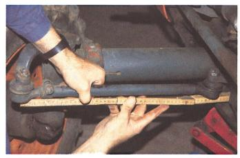
2. Avant de démonter une rotule, mesurer précisément la longueur de la barre de direction en question d'un axe à l'autre. Notez cette longueur pour ensuite remonter la barre. Ceci vous facilitera le réglage ultérieur de la direction.
