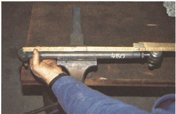
5. Avant de remonter la rotule, on veillera à respecter la longueur de la barre mesurée précédemment. Les pas de vis devraient être de même longueur de chaque côté du levier. Si besoin est, on changera le capuchon endommagé de la rotule encore en place. Bien surveiller que les sièges coniques de rotules regardent dans la même direction lors du serrage du contre-écrou.
