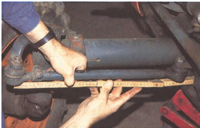
2. Avant de démonter une rotule, mesurer précisément la longueur de la barre de direction en question d'un axe à l'autre. Notez cette longueur pour ensuite remonter la barre. Ceci vous facilitera le réglage ultérieur de la direction.
