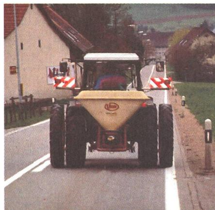
Si l'installation électrique cache les feux du véhicule, les feux sur les roues jumelées, combinés avec des feux arrière et des clignotants offrent un maximum de sécurité.
