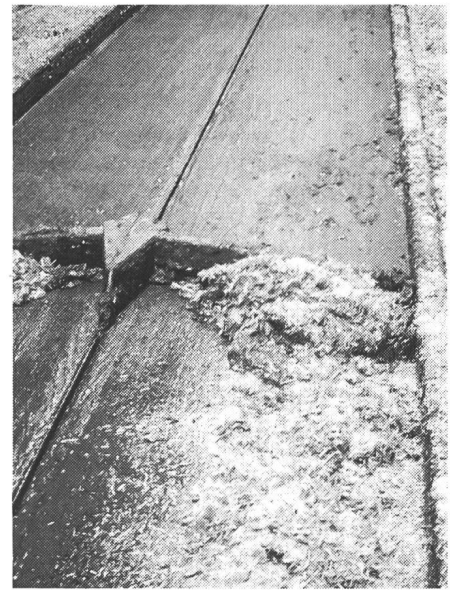
Le mouvement de rotation de l'évacuateur à spirale favorise l'élimination des jus de fumier.
