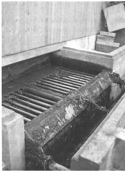
La largeur d'évacuation du racleur rétractable verticalement doit rester constante.
