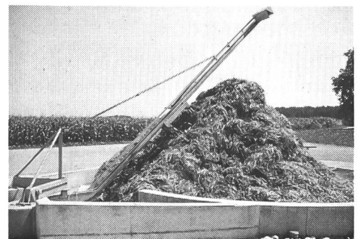
La rampe à fumier offre une sécurité fonctionnelle élevée pour tous les types de fumier et s'avère relativement avantageuse financièrement.
