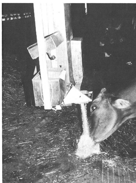
Fig. 7. L'aliment est distribué sur le bord de la crèche par le DAC mobile. Ceci empêche que la ration ne soit mangée par les vaches voisines.
