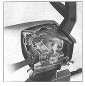
Le catalyseur est intégré de façon compacte dans le silencieux et consiste en un élément métallique revêtu de métaux nobles. Il en résulte que les substances nocives sont brûlées à près de 1000 °C. Le silencieux et les gaz sont refroidis par l'air du ventilateur. Le catalyseur ne demande aucun entretien et a la même durabilité que les autres pièces vitales du moteur, à condition que l'on fasse le plein avec de l'essence sans plomb.
