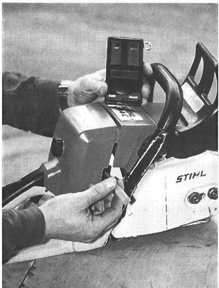
Le carburateur ne peut être réglé correctement qu'au moyen d'un compteur électronique de tours-minute.
