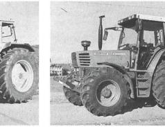
Fig. 4. Tracteur FENDT 509 C turbo avec système hydraulique frontal et prise de force frontale.
