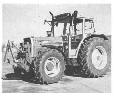
Fig. 3. Tracteur MASSEY FERGUSON 390 turbo avec système hydraulique frontal et prise de force frontale.
