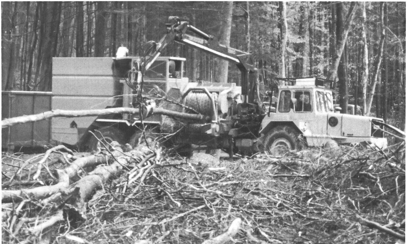
Déchiqueteuse mobile équipée sur un Volco BM. Une organisation de travail optimisée a une influence considérable sur le travail: le rendement à l'heure oscille entre 50 et 100 mètres cubes.
