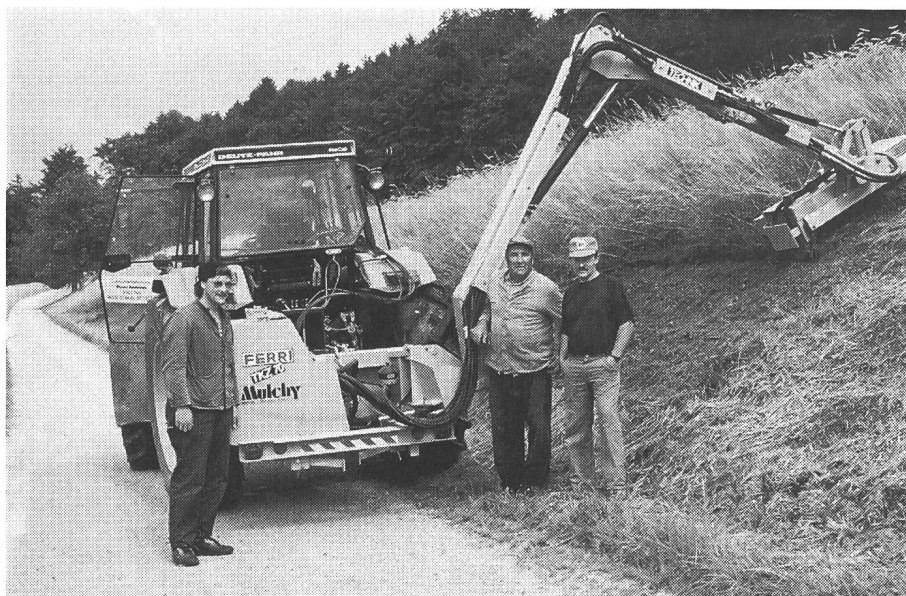
Grand intérêt accordé aux travaux communaux: entretenir les chemins champêtres et soigner les talus, en bordure des chemins avec le nouvel appareil de mulching que l'on peut aussi équiper d'une faucheuse à deux rangs. Machine conçue par Andreas Peier, son père Georges et Ernst Blösch. (Photo Zw.)
