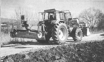
Deux éléments importants pour l'entretien des chemins champêtres: le vibrateur avec une rangée de dents pour ouvrir la couche marneuse et...
