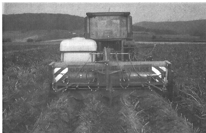
Fig. 2. Le broyage des fanes et le traitement par bandes avec deux buses «Teejet OC-02» par ligne ont donné de bons résultats pour toutes les années d'essai (60% de produits économisés, défaneuse déposant les fanes dans les sillons).
