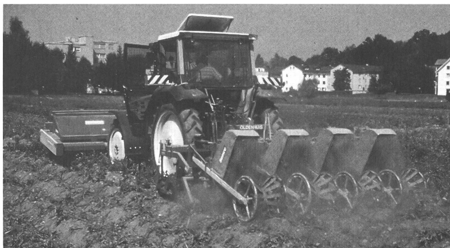
Fig. 1. Par combinaison de la défaneuse et de l'arracheuse, les fanes broyées sont déposées dans les sillons et les tiges restantes sont arrachées à l'aide de rouleaux en caoutchouc (tracteur 61 kW quatre roues motrices, pneus 11 pouces, prise de force 1000 t/min, Hürlimann 488 DT, 3610 kg + 1985 kg défaneuse et arracheuse Oldenhuis, Samro Burgdorf).
