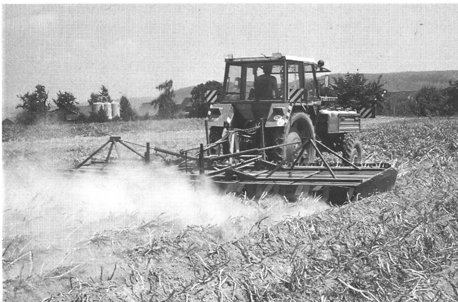
Fig. 4. La défaneuse thermique Schaffner (980 kg) a été utilisée avec un porte-outils 40 kW. Le gaz propane liquide est enflammé électriquement et entre en combustion dans 24 brûleurs. L'efficacité de ce système est contrebalancée par de nombreux effets secondaires indésirables, tels que les émissions de fumée etc.
