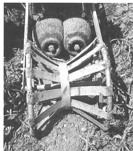
Fig. 1. Par combinaison de la défaneuse et de l'arracheuse, les fanes broyées sont déposées dans les sillons et les tiges restantes sont arrachées à l'aide de rouleaux en caoutchouc (tracteur 61 kW quatre roues motrices, pneus 11 pouces, prise de force 1000 t/min, Hürlimann 488 DT, 3610 kg + 1985 kg défaneuse et arracheuse Oldenhuis, Samro Burgdorf).
