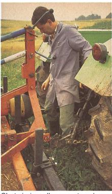
C'est ainsi que l'on se met en danger. Il ne faut jamais toucher à l'hydraulique lorsque l'on se trouve entre la machine et le tracteur.
