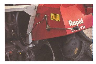
... c'est pourquoi les interrupteurs par contact électroniques sont préférables. Il s'agit de les monter latéralement, de façon à empêcher l'accès entre le tracteur et la machine.
