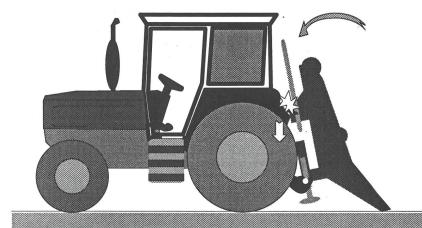
Exemple d'accident: Alors qu'il voulait libérer le support du treuil forestier, un agriculteur a malencontreusement actionné le levier de commande du système hydraulique en se penchant en avant. Le relevage s'est abaissé et, comme le bras de maintien supérieur était déjà décroché, la machine s'est inclinée contre le tracteur. La tête de l'agriculteur a été coincée entre le garde-boue et la grille de protection
