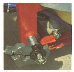
Voilà un mauvais exemple de goupille de sécurité. En effet, elle ne peut se fixer à la machine. Les goupilles sûres disposent d'un trou de fixation séparé et sont attachées au moyen d'une chaînette.
